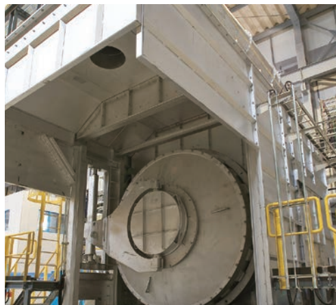
ダイセキMCR宇都宮リサイクルセンターの回転ガス熔解炉
