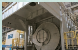
廃鉛の溶解工程 (回転ガス溶解炉)
