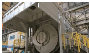
回転ガス熔解炉（ロータリーファーンズ）
