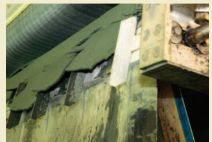
ベルトプレス式脱水機による銅回収
