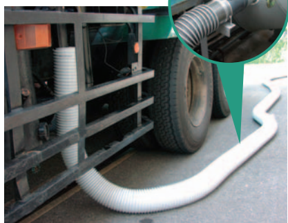
バキューム車の排気ガスは脱臭装置に繋ぎ込み除去
