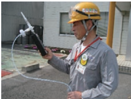
臭気センサーを使って日常監視（千葉事業所）
