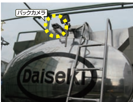
大型車両にバックカメラ設置
